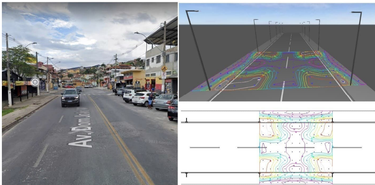
Figura 11 – Planta Esquemática Posteação Bilateral Frontal
